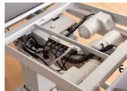
Die fünf Motoren sind servicefreundlich direkt unter dem abnehmbaren Sitzteil positioniert.
